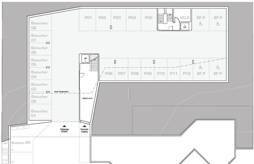
Abb. Untergeschoss mit Einstellhalle (Norden links)
